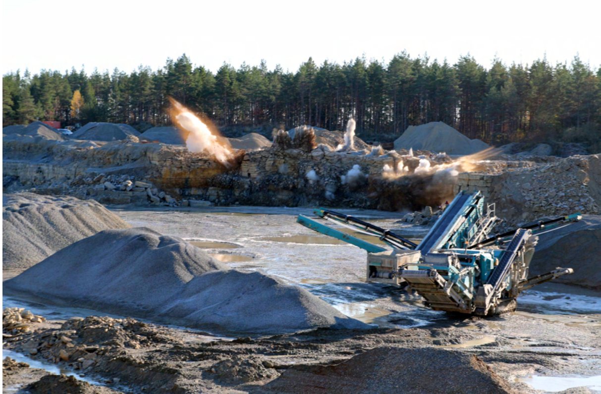
Foto 2. Lõhkamine Tarva karjääri 24.10.2017. Kivimitükkide lennukaugus ei ulatunud purustussõlmeni, mis asus lõhkekohast mõnekümne meetri kaugusel. Lõhkeaine kogus lõhkamisel oli 41 laengukaugus kokku ca 1,2 tonni.
